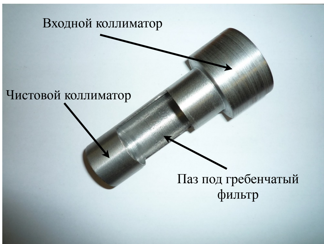
Рисунок 6.6. Внешний вид оправки для крепления гребенчатого фильтра.
