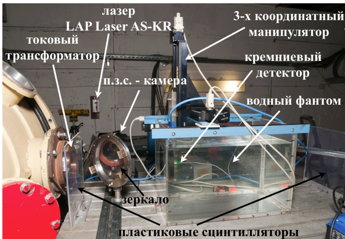
Рисунок 2.3. Внешний вид экспериментальной установки и ее основных элементов.
