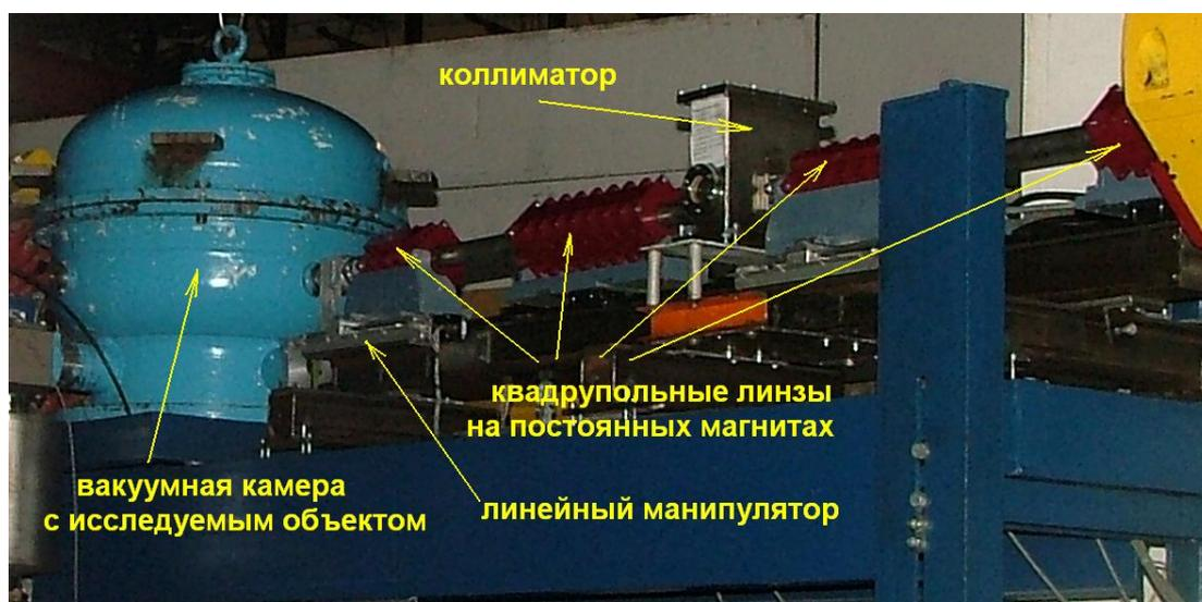
Рисунок 3 - Фотография протонного микроскопа ПУМА.
