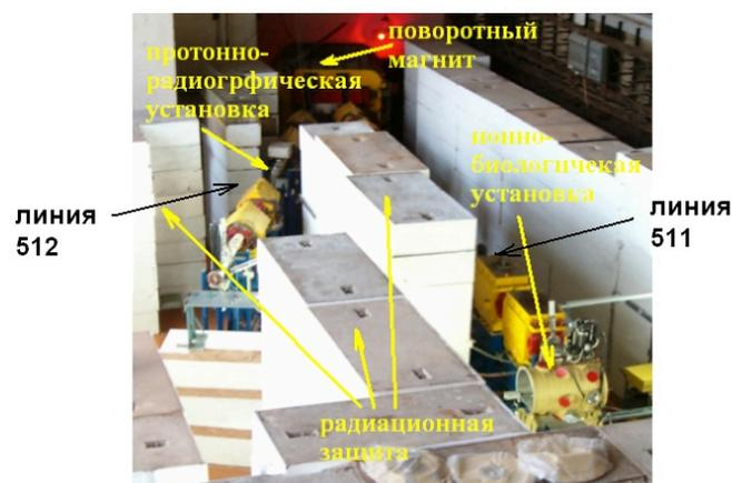
Рисунок 2.3 - Фотография линий 511 и 512 установки ПРИМА
