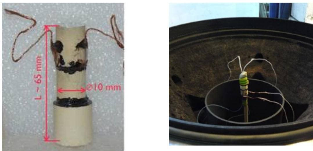
Рисунок 4.1 - Заряд из прессованного ТНТ с плотностью  $1,63 \text{ г/см}^3$ .
