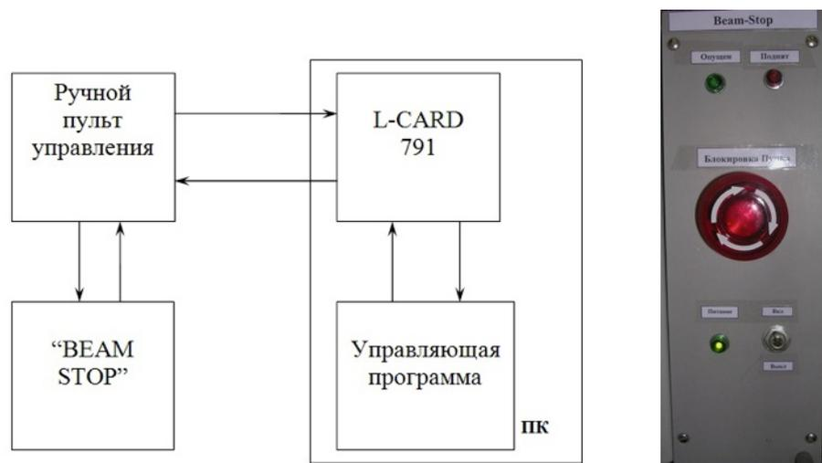
Рисунок 3.19 - Слева - схема управления блокиратором пучка. Справа – фотография ручного пульта управления блокиратором пучка.
