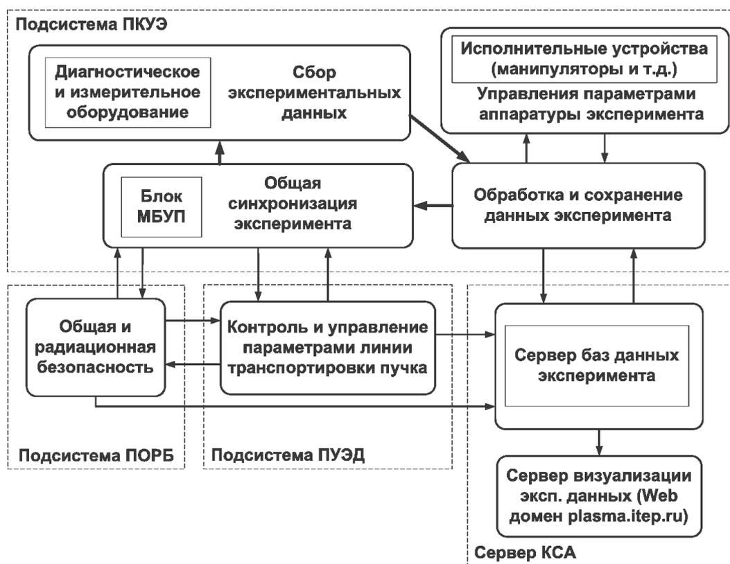
Рисунок 3.1 - Функциональная схема подсистем комплексной системы автоматизации экспериментов КСА.
