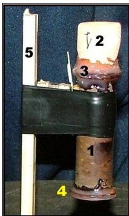
Рисунок 4.4 - Фотография заряда эмульсионного взрывчатого вещества диаметром 15 мм; 1 - пластиковая оболочка с исследуемым зарядом ЭВВ, 2 - инициирующая таблетка ВВ (ТГ 50/50), 3 - плексигласовый фланец, 4 - узел для исследования скорости поверхности с помощью интерферометра VISAR, 5 – крепежная рейка.
