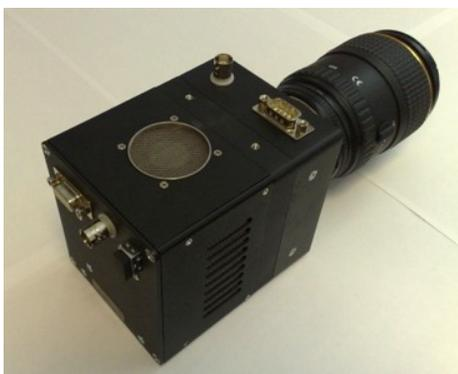
Рисунок 2.9 – Фотография ПЗС камеры S2C-077FO-G с установленным ЭО усилителем и затвором
