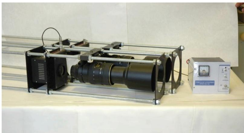
Рисунок 2.8 - Фотография двух каналов регистрации радиографических изображений. Слева – два канала регистрации созданных с использованием ЭО бипланарного затвора на основе ПЗС камер S2C-017APF-K2, справа- генератор высоковольтных импульсов ГВИН-1
