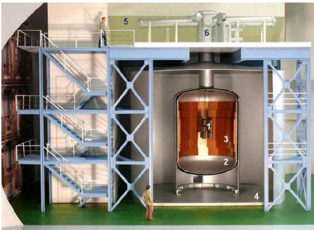
Рис. 7. Модель установки GERDA. 1 – массив детекторов, 2 – криостат с жидким аргоном, 3 – медная защита, 4 – водный бак с черенковской системой мюонного вето, 5 – лабораторные комнаты, 6 – запорный механизм.
