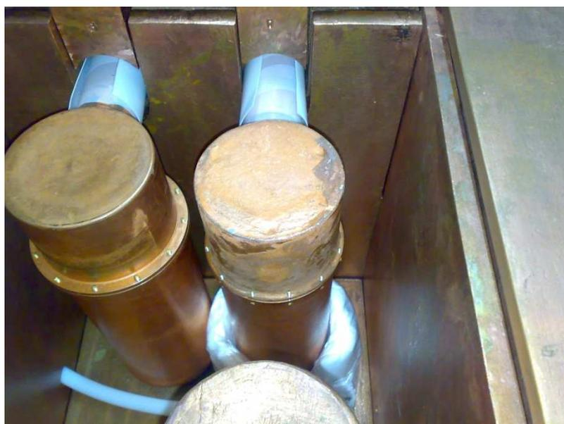
Рис. 34. Фотография рабочей полости спектрометра с образцом, размещённым вокруг детектора №3.
