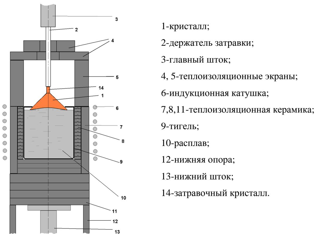
Рис. 19. Схема выращивания кристаллов методом Чохральского.
