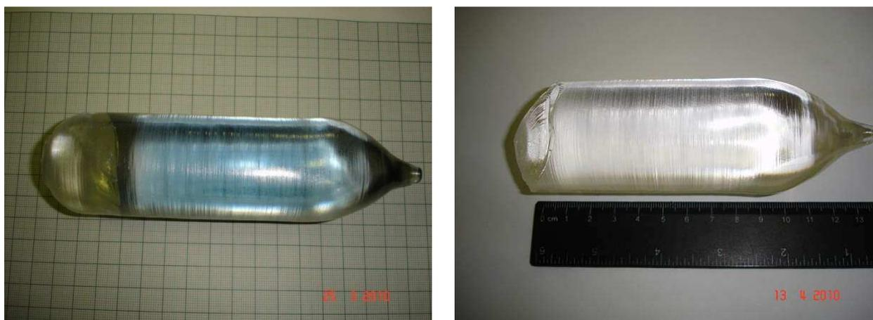
Рис. 20. Выращенная буля до отжига (слева) и после отжига (справа).
