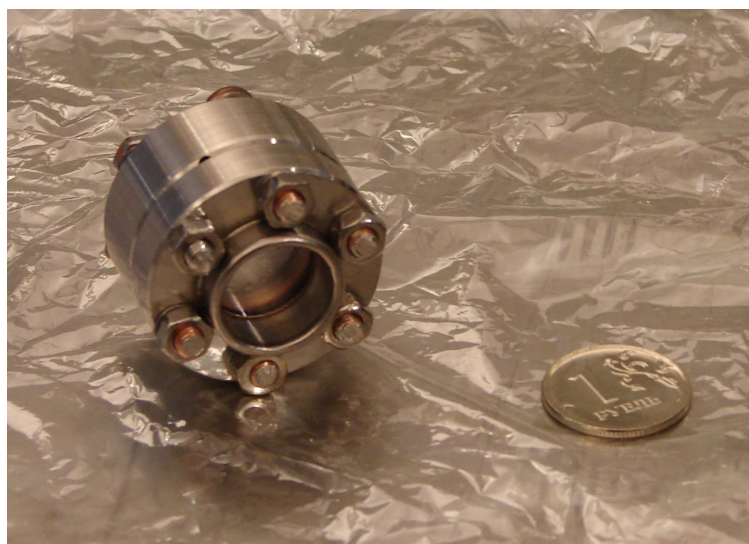
Рис. 3.4: Фото переизлучателя (собранные в атмосфере аргона фланцы)
